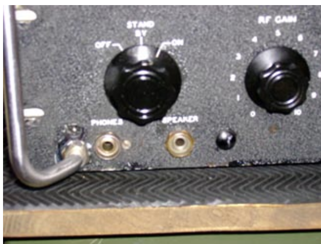
Particolare dei Jack restaurati e del "tappo"
