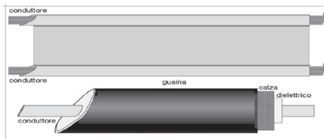
Nella figura, In alto è la linea bifilare, in basso quella coassiale.
